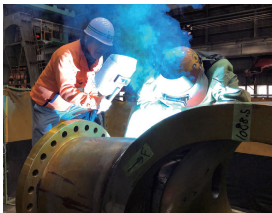
【作業風景】圧縮機ケーシングの溶接指導
